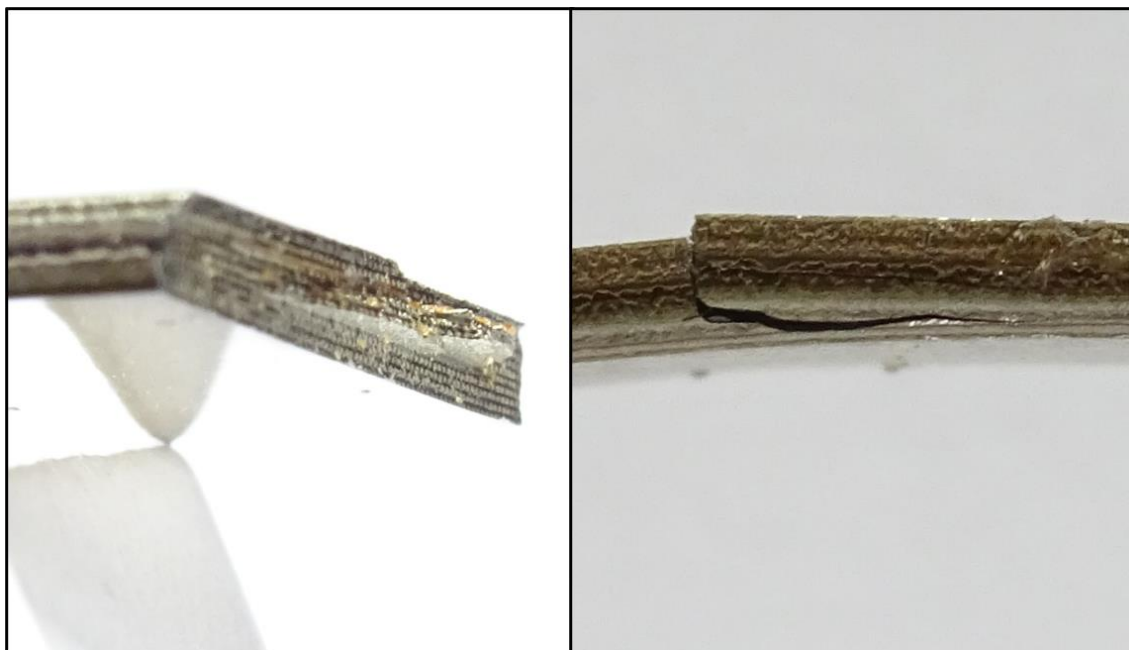
Abb. 5-9: Bruchflächen der Proben BP_0,1mm_7,4%A (links) und BP_0,1mm_7,4%B (rechts)
